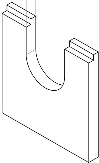
Gehäuse mit Nut - Federsystem
