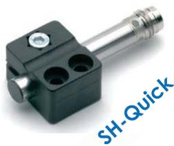
Unsere Sensorenhalter SH- und SHE-Quick bestehen aus einem kompakten Bauteil, zusätzlich sind die SHE-Quick aus rostfreiem Stahl gemacht. Dadurch bleibt die Position des Halters beim Wechsel der Sensoren erhalten. Es muss lediglich die Klemmschraube gelöst und nach Sensorenwechsel wieder festgezogen werden.
