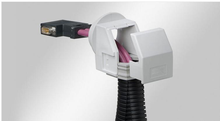
可分的KVT-W90电缆格兰头用于以90°角引入和密封预先端接的电缆。它同样适用于不带端子或连接器的电气, 气动或液压管线以及波纹管(例如引入控制面板, 机柜或机械设备), 并满足IP54防护等级。
