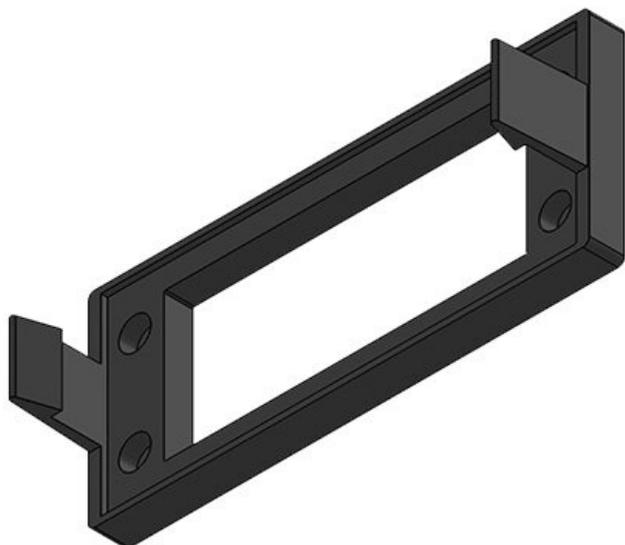
易科智连 KEL-SNAP 框架可作为KEL / KEL-U / KEL-QUICK / KEL-FG-A电缆引入系统的快速卡入组件。交付时, 控制面板, 机柜或机器可以配备KEL-SNAP框架, 从而在安装时可以轻松卡入KEL框架。非常适合需要大量维护的机箱或后续安装的机箱。
