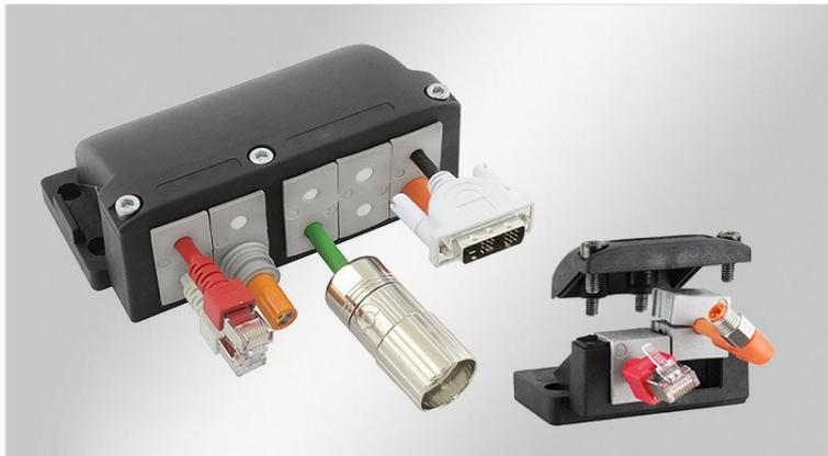
KEL-FG电缆引入框架适用于带有连接器的电缆和波纹管安装，密封和释放应力，该电缆与机柜，机壳或机器壁成90°角。
