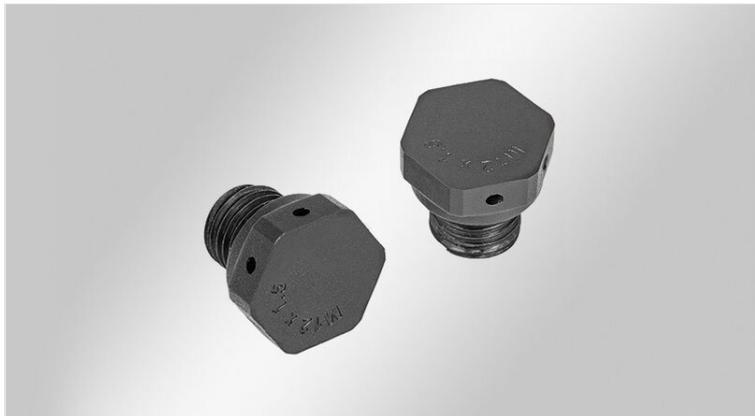
メートル規格M12x1.5のネジ付き圧力補正エレメントPCEは、圧力補正に優れています。温度変化によって生じる負圧を防ぎ、筐体への水分侵入を防止します。これにより、保護等級IP68が保証されます。
