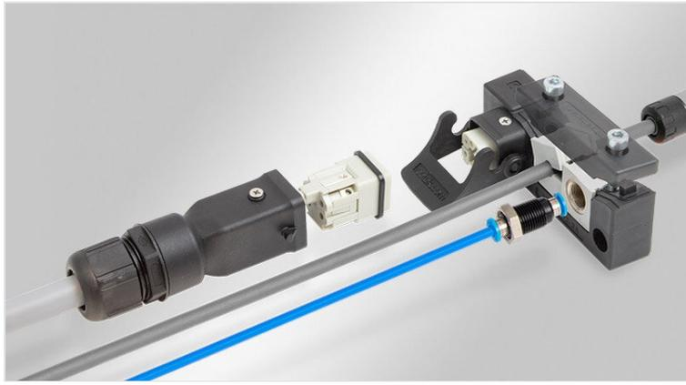
Modular Interface System (MIS) は、端末処理済ケーブルを配線する分割形ケーブルエントリーでありながら産業用角形コネクタ3Aまたは4Aも一緒に複合できる製品です。サイズ3Aまたは4Aの産業用コネクタを直接フレームに嵌合できます。ケーブル径1~15mmを配線でき、EN 62444に準拠したストレインリリーフ機能を満たしています。
