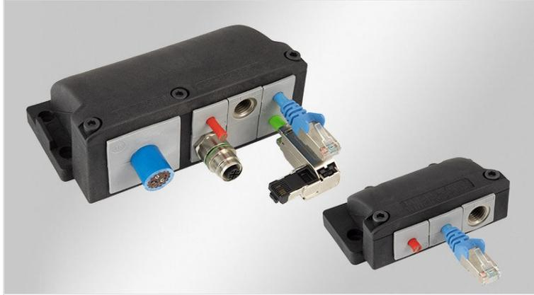
ケーブルエントリーフレームKEL-FG-ERは、キャビネット、壁に対して90°の角度でケーブルを挿入し、シールし、ストレインリリーフすることができます。コネクタの有無にかかわらず、ケーブルやホースをスムーズに挿入できます。サイズに応じて、外径1~16mm(1穴グロメットKT 1~15に対応)、または13~35mm(1穴グロメットKTG 13~KT 34に対応)のケーブルを挿入でき、IP65でシールされ、同時にEN 62444に準拠したストレインリリーフ機能を発揮します。
