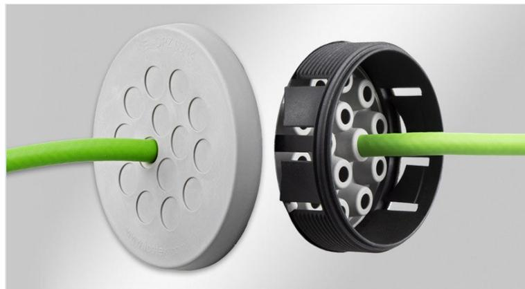
KEL-DPZ-CLICK丸型ケーブルエントリプレートは、外径1.5～22mmのさまざまなケーブルを僅かなスペースにまとめて挿入でき、保護等級IP65/IP66/IP68/(DIN EN 60529準拠)で2重にシールすることが可能です。また同時に、ケーブルの歪みを解消しています。
