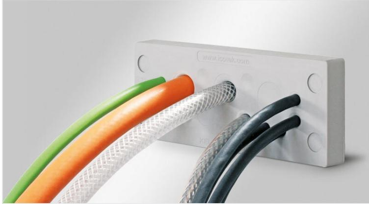
Il passacavo a membrana KEL-DPU per cavi e guaine pneumatiche o idrauliche di diametro da 3.2 a 20.5 mm si caratterizza per la sua anima particolarmente rigida realizzata in polipropilene, completamente ricoperta da elastomero. Questo consente di ottenere una elevata protezione di ingresso, ed una considerevole tenuta allo strappo sui cavi inseriti.
