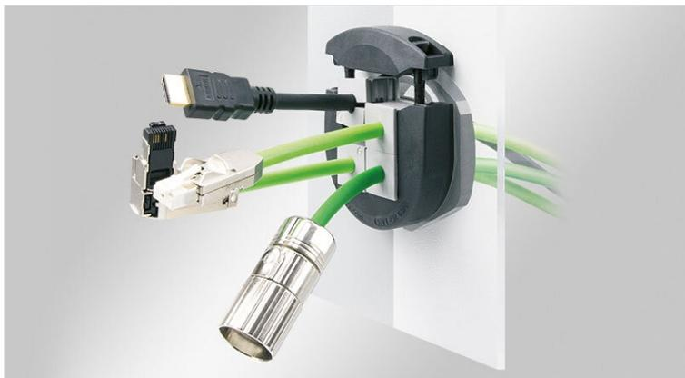
Le KVT-ER est un presse-étoupe divisible conçu pour le passage et la protection de câbles avec connecteurs ou de faisceaux de câbles complets. Il permet également d'introduire des gaines pneumatiques ou hydrauliques, qu'elles soient lisses ou annelées (par ex. dans des machines, armoires électriques...) en assurant leur étanchéité et une forte résistance selon EN 62444.
