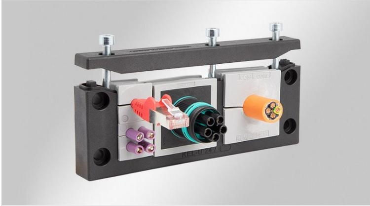
Système divisible pour le passage de câbles et faisceaux équipés de connecteurs ainsi que des gaines et tuyaux pneumatiques, avec étanchéité IP54 / UL Type 12 et fonction serre-câble selon EN 62444.
