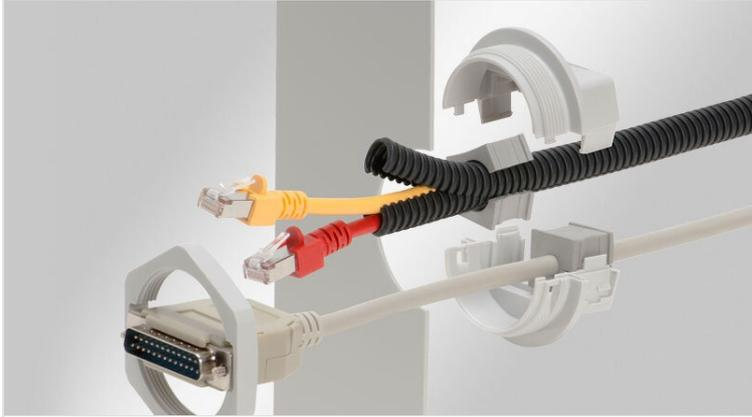
Les KVT sont des presse-étoupes au pas métrique qui permettent de faire passer des câbles pré confectionnés ou des faisceaux de câbles prêts-à-l'emploi. Il permet également d'introduire des gaines pneumatiques ou hydrauliques, qu'elles soient lisses ou annelées (par ex. dans des machines, armoires électriques...).
