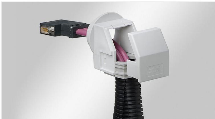
Le Presse-étoupe à clipser KVT-W90 permet d'introduire à 90° des câbles pré confectionnés ainsi que des gaines pneumatiques ou hydrauliques, qu'elles soient lisses ou annelées (par ex. dans des machines, armoires électriques...).
