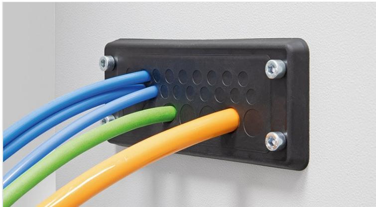
La placa pasacables KEL-DPR 24 se basa en la acreditada KEL-DP 24, pero tiene un marco de refuerzo de polipropileno integrado. Con la KEL-DPR 24 se pueden insertar hasta 48 cables de 1 a 16,1 mm y conseguir un sellado conforme a IP65. La entrada de cables KEL-DPR 24 se adapta a los recortes estándar para conectores de alta resistencia de 24 polos.
