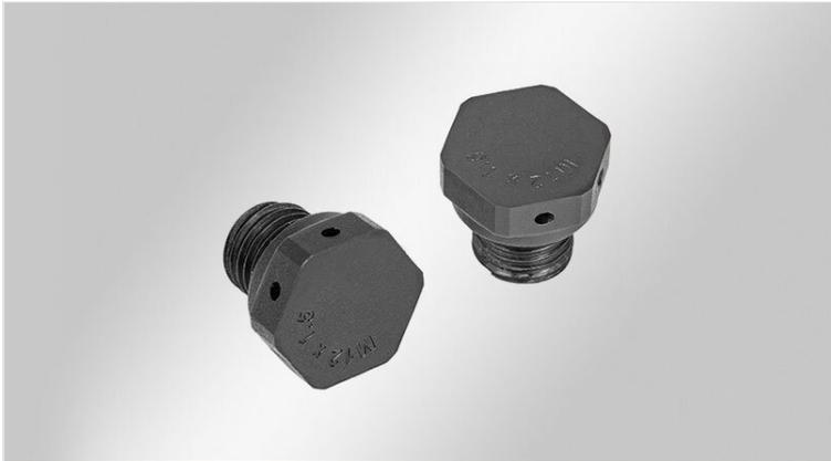
El elemento de compensación PCE con rosca M12x1,5 es usado para evitar las variaciones causadas por la presión por diferencias en temperatura. Por lo tanto, previene los daños causados por condensación. Ofrece un grado de protección IP68.
