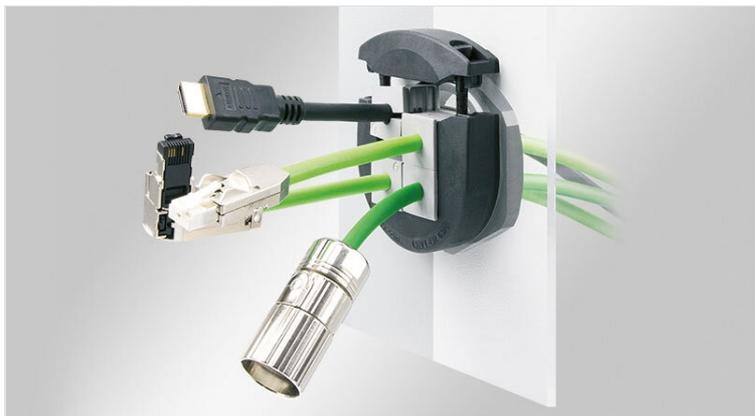
KVT-ER son prensaestopas partidos para paso y sellado de cables con conectores o mazos de cables completos, con diámetros desde 1 a 16 mm (KT 1 - 15) y de 13 a 35 mm (KTG 13 - KT 34).
