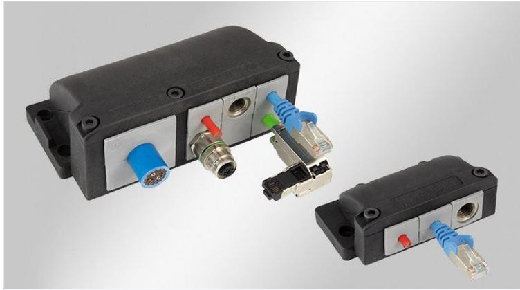
Los cajas pasamuros acodados KEL-FG-ER son adecuados para la instalación, sellado (protección de IP65) y sistema antitracción de cables con conectores y tubos con diámetros desde 1 a 16 mm (insertos KT 1 - 15 de un solo agujero) y desde 13 a 35 mm (insertos KTG 13 - KT 34 de un solo agujero), en un ángulo de 90° con respecto al armario, a la caja o a la pared de la máquina.
