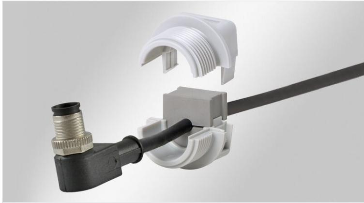
Die teilbare Kabelverschraubung QVT ermöglicht die schnelle Einführung von Leitungen mit Steckern oder fertigen Kabelsätzen. Aber auch nicht konfektionierte elektrische, pneumatische oder hydraulische Leitungen sowie Wellschläuche lassen sich mit der teilbaren Kabelverschraubung QVT problemlos in Schaltschränke, Gehäuse oder Maschinen einführen und abdichten.
