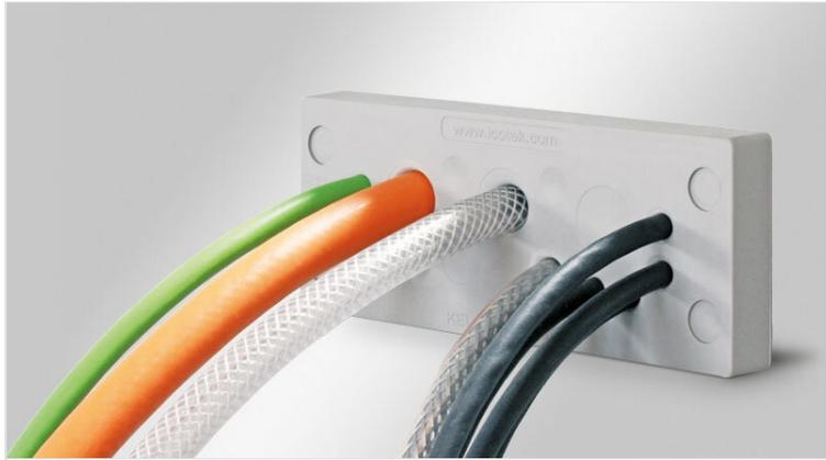
Die robusten Kabeldurchführungsplatten KEL-DPU ermöglichen es, auf engstem Raum viele Leitungen mit unterschiedlichen Durchmessern von 3.2 bis 20.5 mm einzuführen und 2-fach mit IP66/IP68\* / UL Type 12/4X\*\* abzudichten.
