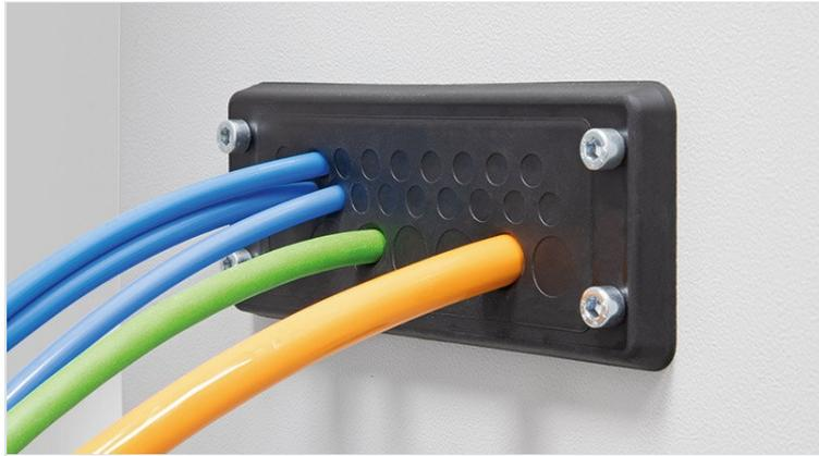
Die Kabeldurchführungsplatte KEL-DPR 24 basiert auf der bewährten KEL-DP 24, besitzt jedoch einen integrierten Verstärkungsrahmen aus Polypropylen. Mit der KEL-DPR 24 können auf kleinstem Raum bis zu 48 Leitungen von 1 bis 16,1 mm eingeführt und gemäß IP65 abgedichtet werden.
