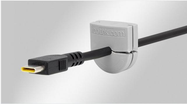
Die UT Kabeltülle ist eine Kabeldurchführungstülle in U-Form und ermöglicht es, einzelne mit Steckern konfektionierte und nicht konfektionierte Leitungen mit Durchmesserbereich 4 - 11 mm in Gehäuse einzuführen.
